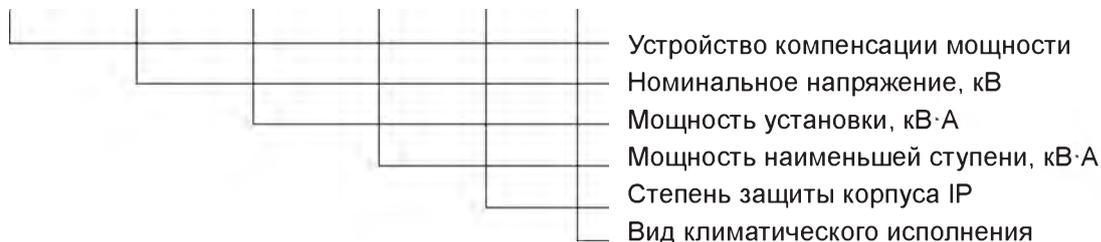
Обозначение при заказе: УКП — 0,4–100–25–30 — УЗ (пример).
