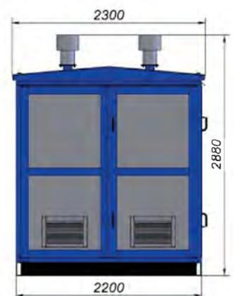
Вариант исполнения 2КТПГSM в одной кабине (ввод воздушный или кабельный)
