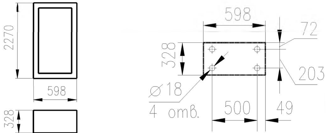
Рис. 8. Габаритные и установочные размеры панели управления
