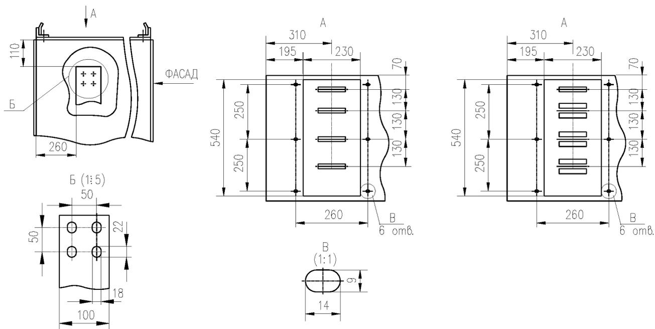
Рис. 5. Выход шинами вверх в шкафах ШВ
